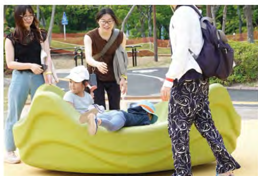
車いすからも移乗しやすい乗り込み高さで、寝そべっても乗れるおわん型の回転遊具。年齢差のある子どもと一緒に楽しめる
