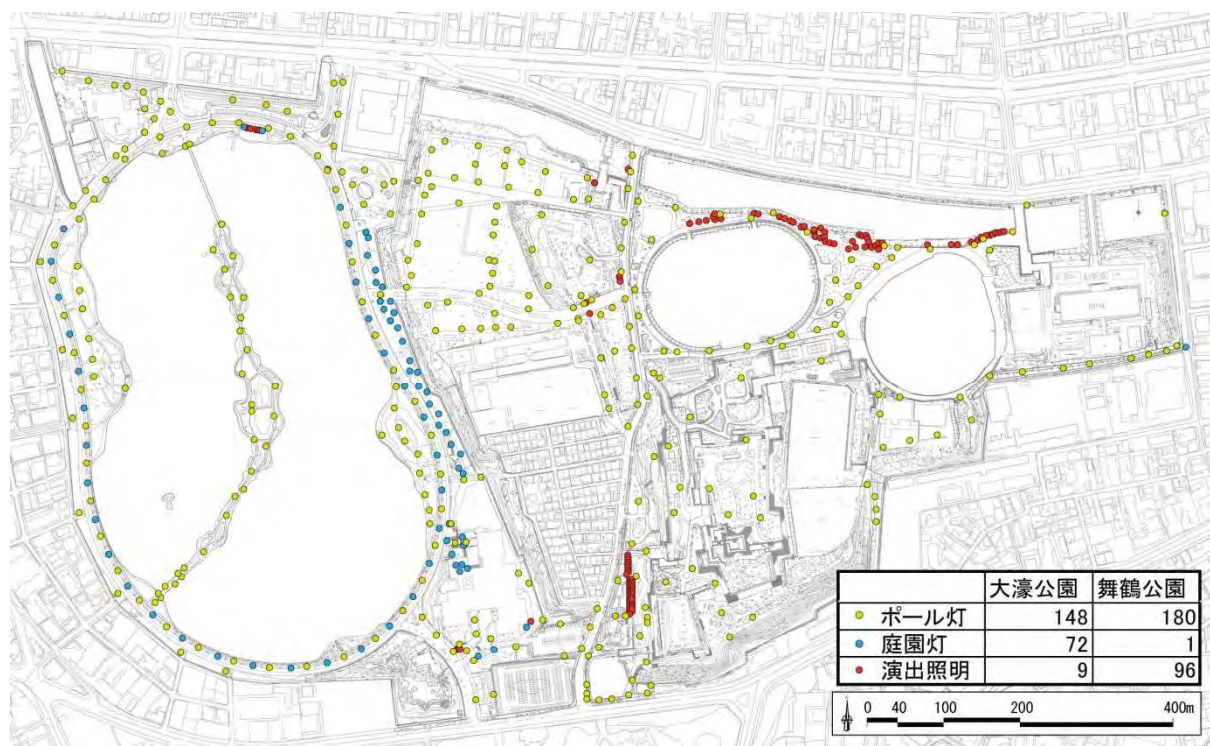
図 照明の設置状況
