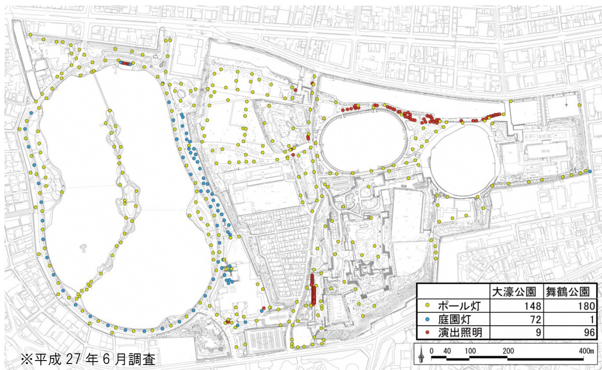
図：照明施設の設置状況
