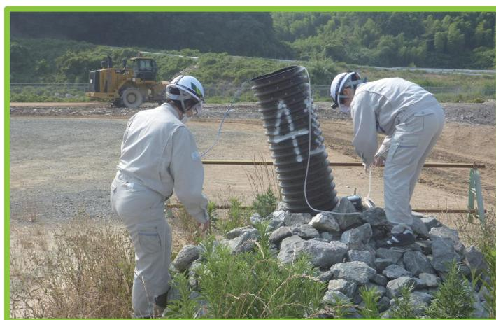
写真2：埋立場のガス抜き管から発生ガスを採取している様子
