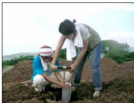
図2 ハンドオーガーを用いたサンプリングの様子
