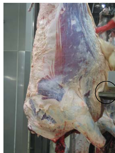
内蔵を取り出す時に急激な落下による腸管の破れを緩和する設備
