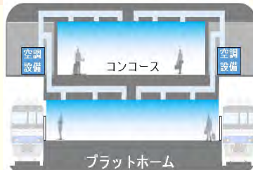
改修後(全体を冷房)
