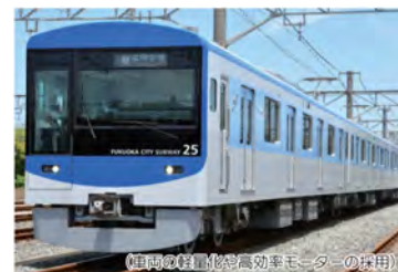
地下鉄車両の省エネルギー化 (車両の軽量化と高効率モーターの採用)
