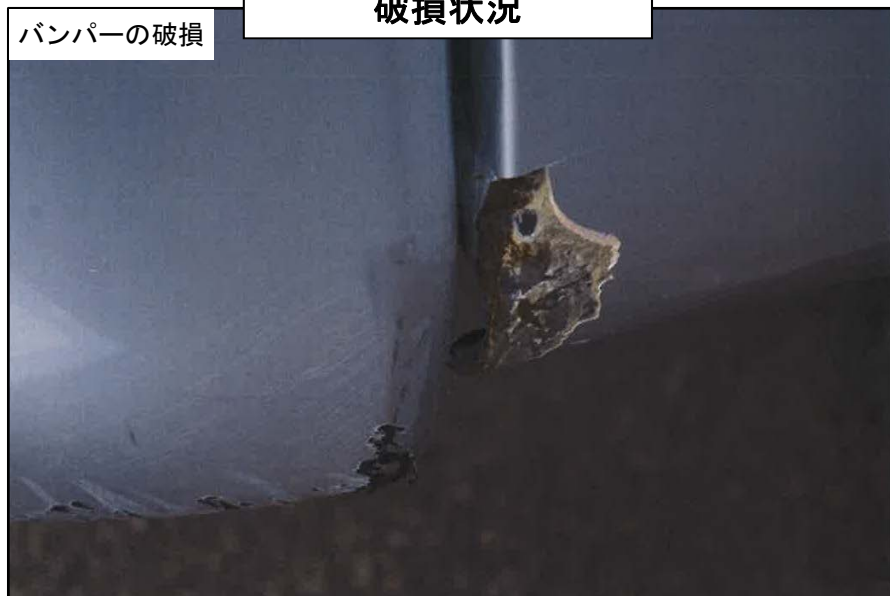
車体下部の変形
