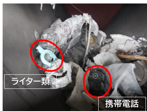
コンベア上に残っていたごみの状況
