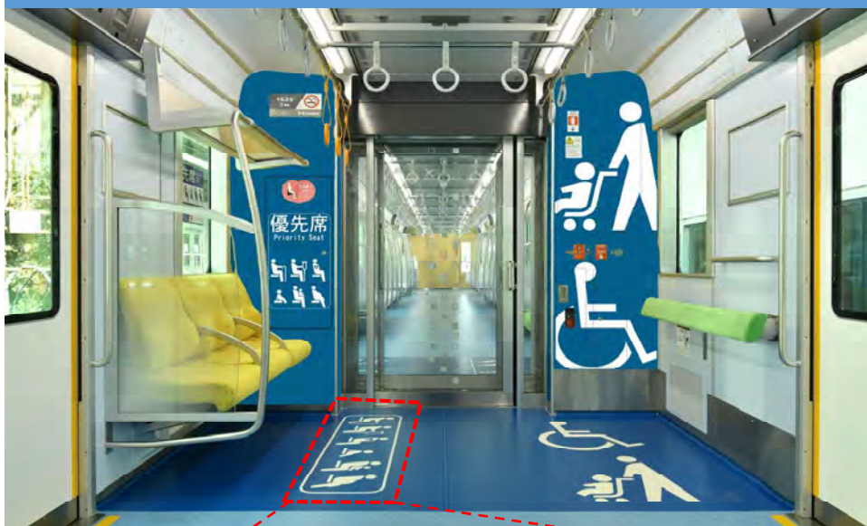
車内優先スペース改修後
