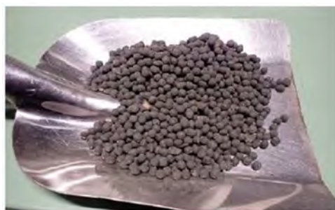
▲固形燃料（製品 直径5mm程度）
