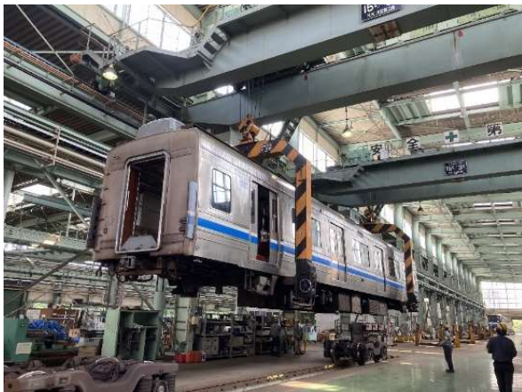
15t/2.8t天井クレーン
