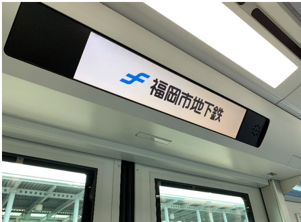
3000A系車両 車内案内表示装置
