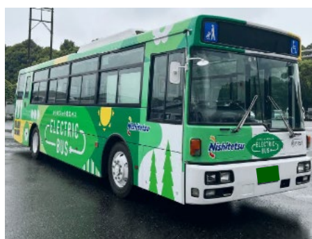
電気バス (レトロフィット電気バス)
