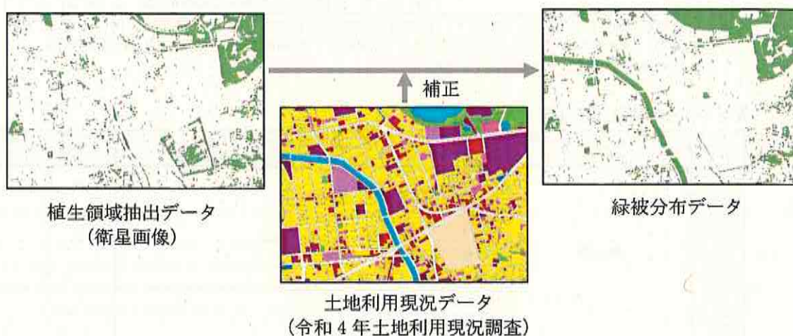
図2-8 植生領域抽出データの土地利用現況データ補正イメージ
