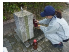
給水栓での採水
