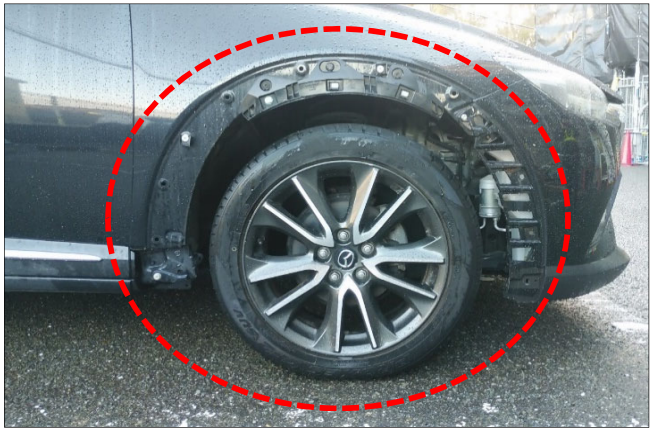
車両損傷状況：右前輪フェンダー部の破損
