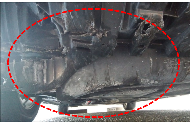
車両損傷状況：前面下部の破損
