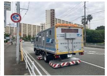
路面下空洞調査
