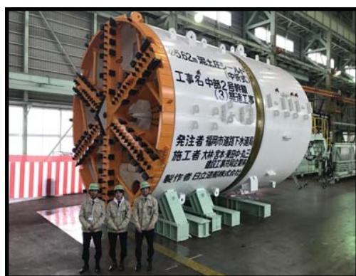
中部2号幹線(掘削前) (鮮魚市場~那の津ポンプ場予定地) シールドマシン(マシン外径5.62m)
