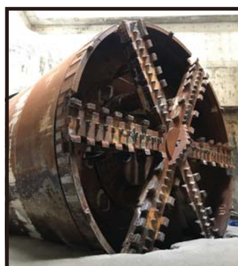
中部2号幹線(掘削後) (鮮魚市場~那の津ポンプ場予定地) シールドマシン(マシン外径5.62m)
