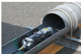
▲下水管内を調査するテレビカメラ
