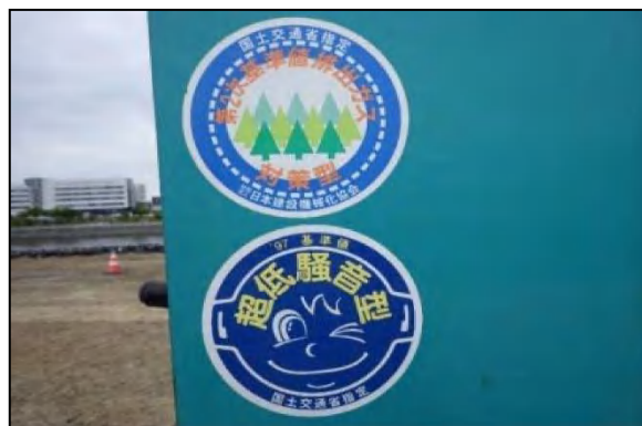
写真①- 4 低騒音型建設機械の採用
