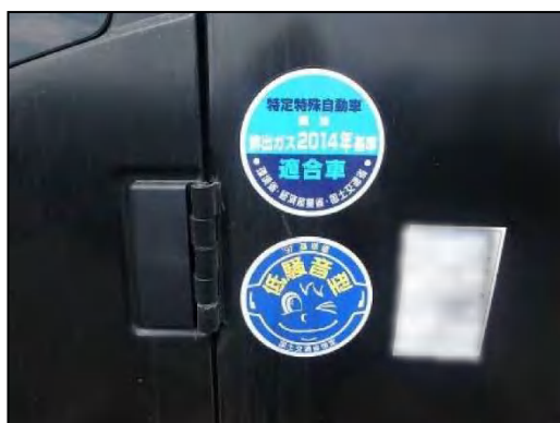
写真②- 3 低騒音型建設機械の採用
