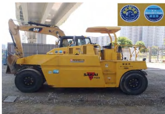
写真②-4 低騒音型建設機械の使用状況
