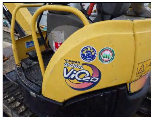
写真④- 4 低騒音型建設機械の使用状況 (近景)
