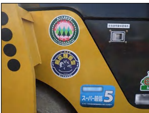
写真③- 3 低騒音型建設機械の採用
