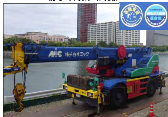
写真③- 7 低騒音型建設機械の使用状況
