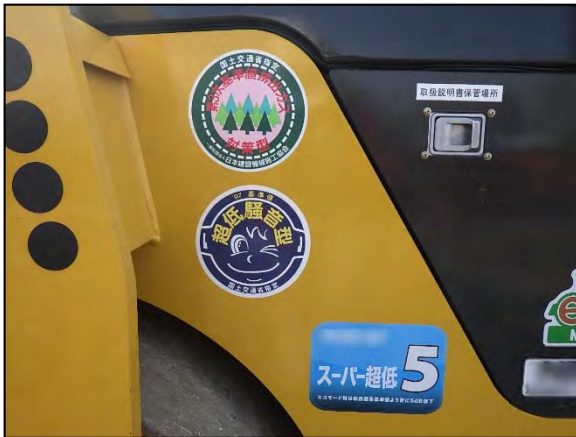
写真③-3 低騒音型建設機械の採用
