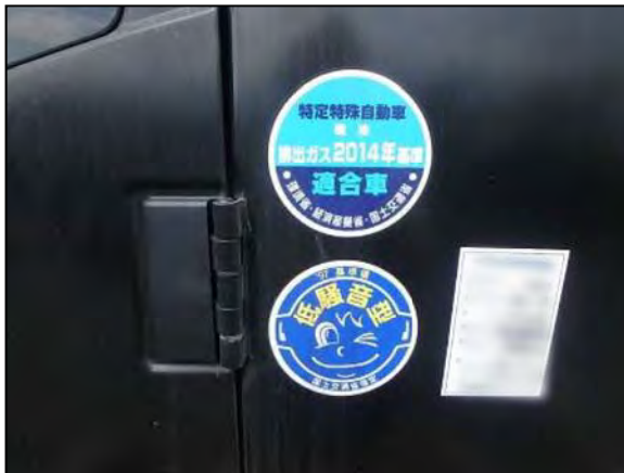
写真②-3 低騒音型建設機械の採用
