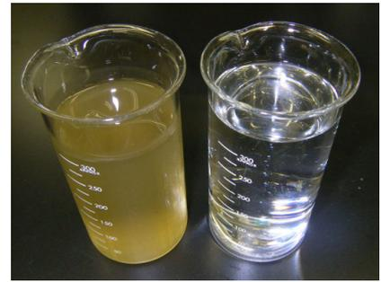
下水中の有機物質(BOD)や浮遊物質(SS)は98~99%の高い除去率で処理されています。また、博多湾の富栄養化対策のため導入した高度処理により、全りん除去率は93%になっています。
