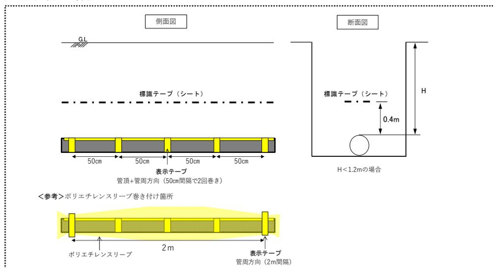
※ 再生水管の埋設標識テープについては、埋設深により設置位置が異なるため、「福岡市再生水管布設基準書」を確認すること。
