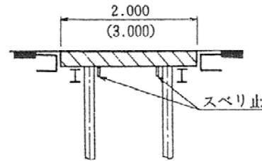
受桁と受け材取付け標準図
