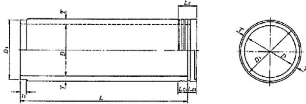
短管A及び短管Bの形状、寸法及び寸法の許容差
