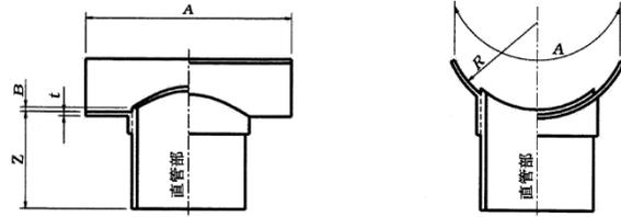
硬質塩化ビニル管用90度及び管軸60度支管
