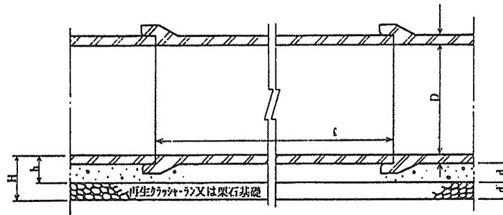
注) 内径350mm以下の栗石基礎の場合は基礎厚  $d'$  を150mmとする。(400mm以上は同厚とする。)
