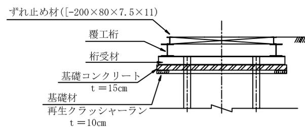
覆工桁、桁受材の規格は、推進工法設計基準編第6章の計算による。
