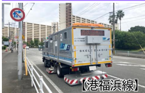
調査事例(路面下空洞調査)
