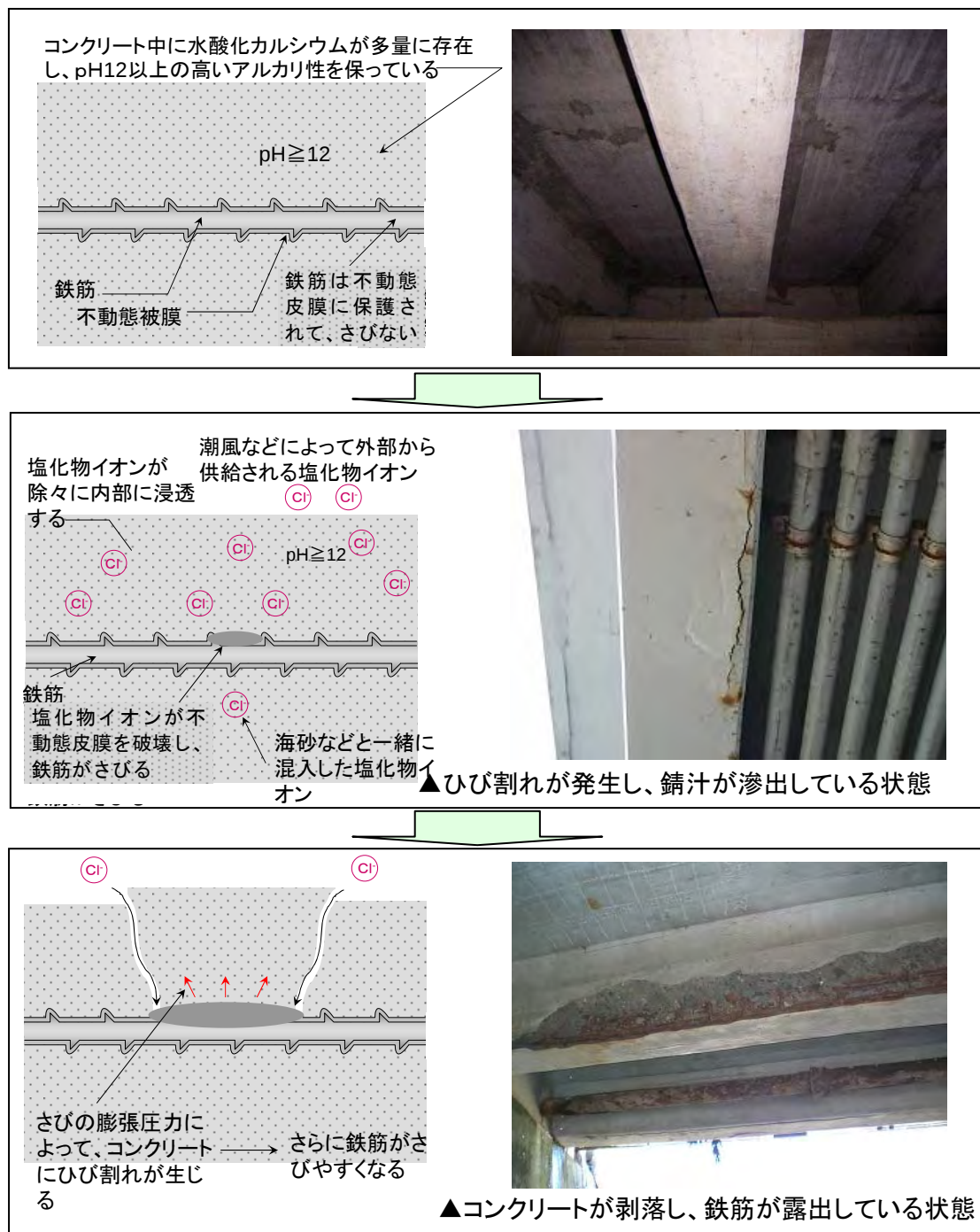
図 6-2 塩害による劣化過程
