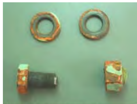
遅れ破壊した高力ボルト (F11T)
