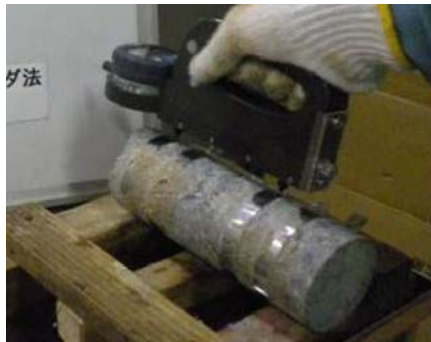
写真 3-3-8 促進膨張用試験体（膨張率測定状況）
