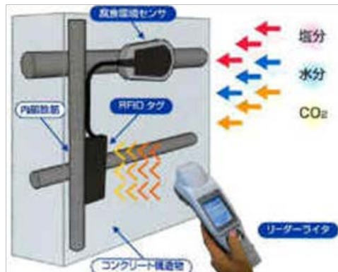
図 3-2-12 腐食環境検知システム（イメージ）
