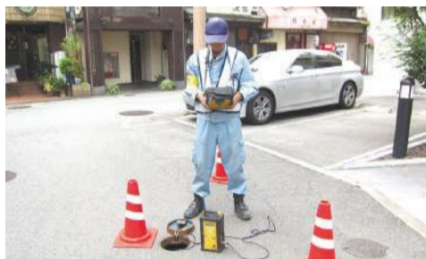
相関式漏水探知器を使用した漏水調査
