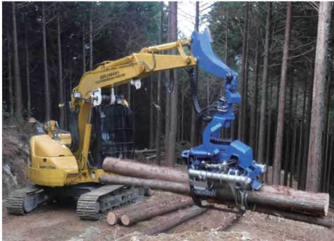
枝を切り落として同じ長さに切り分ける「プロセッサ」
