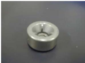
金属片は炊飯器の内釜に使用されたリミッター(一定温度になるとスイッチが切れる)の一部で、混入した原因はコンポートを鍋で調理中その横で壊れた炊飯器
