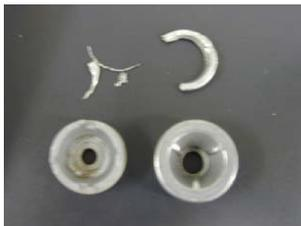
再度原子吸光度計とエネルギー分散型分光計(EDS)でその金属片の組成を調べたところ、異物と金属片はともに通常
