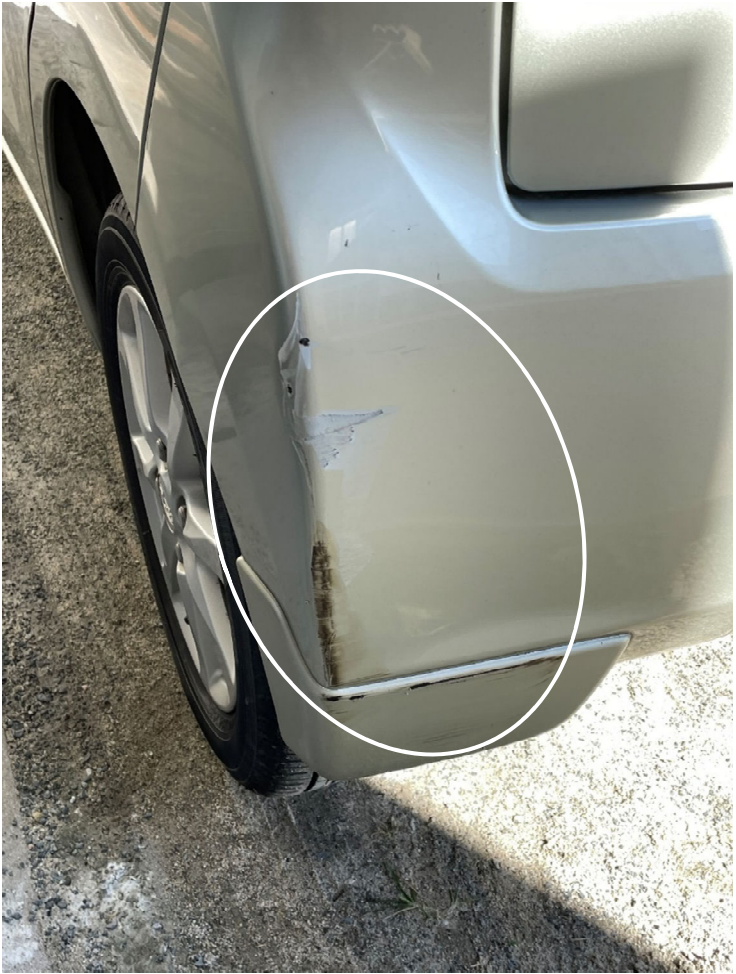
左リヤバンパーの損傷
