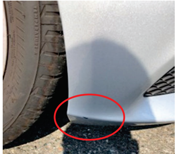
拡大写真① バンパーの傷
