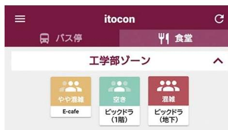
て公開しています。混雑の計測はWiFiやBLE(Bluetooth Low Energy)の出す電波をもとに周辺のスマートフォンの台数を推定し、センサ設置周辺空間の混雑度として可視化する仕組みです。伊都キャンパスでは、周辺11カ所のバス停および9カ所の食堂の混雑状況がリアルタイムに確認できるようになっています。この混雑情報を活用して、キャンパスにおける行動変容を促す研究開発が進められています。また、「itocon」は、コロナ禍における公共交通利用促進策の事例として、国土交通省のWebサイトにて紹介されています。
