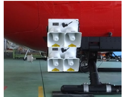
■スピーカー 上空からの避難誘導など広報活動に使用します。
