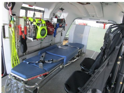
■救急資機材 傷病者の搬送など救急活動に使用します。傷病者をストレッチャーに乗せたまま、機体後方から機内に収容することができます。(新機能)
