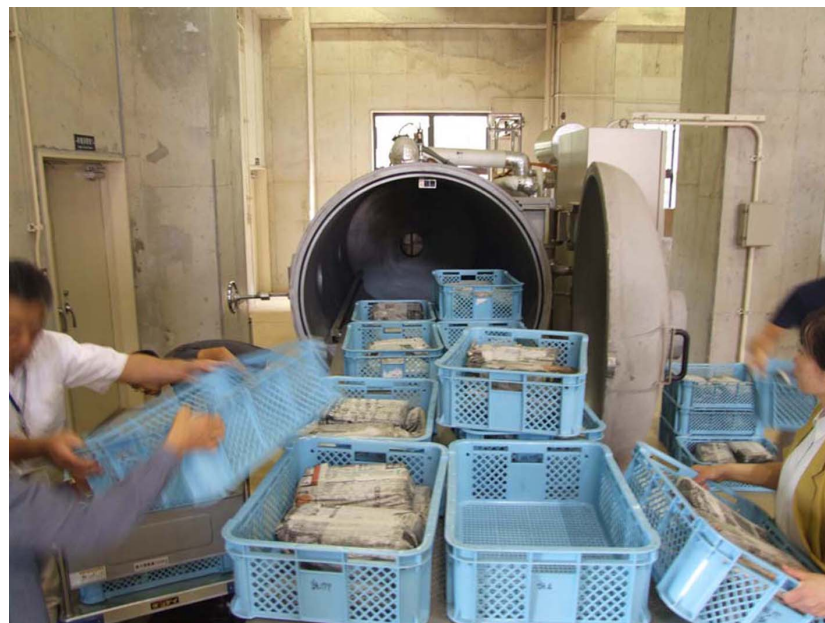
水害で被災した文書の真空凍結乾燥処理
