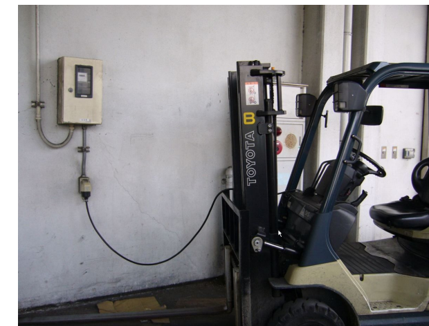
充電コンセントにフォークリフトからのプラグを差し込む
