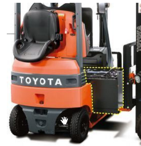
フォークリフトでバッテリーを交換
