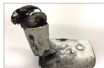
発火原因となった加熱式タバコ (リチウムイオン電池内蔵)
