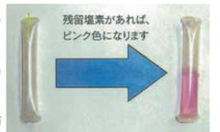
区衛生課では、水道水の残留塩素を検査する「パックテスト(検査キット)」を無料で配布しています。水質検査にご利用ください。 区衛生課 ☎831-4219 ㊟843-2662
