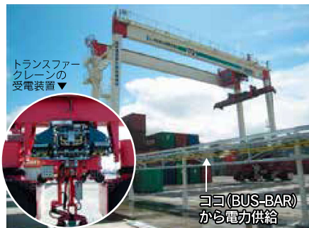
※1 トランスファークレーン コンテナを積み降ろしするためのクレーン
