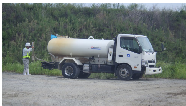
工事区域内の散水車両
