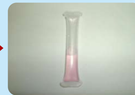
ピンクに色が付けば大丈夫! 塩素の消毒効果が残っている証拠です。
