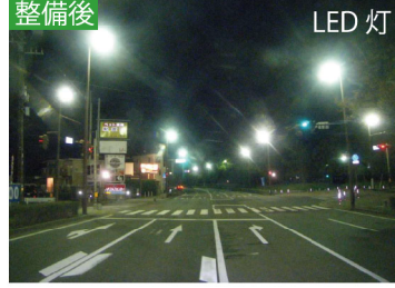
道路照明灯のLED化
