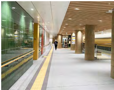
床と壁にコントラストがあり、空間認識がしやすい。柱や手すり等認識してほしいものは周囲とコントラストをつけている。
