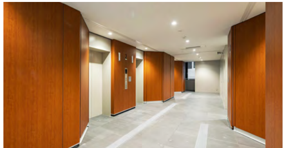
床と壁にコントラストがあり、空間認識がしやすい。エレベーターの扉は周囲の壁とコントラストがあり、認識しやすい。
