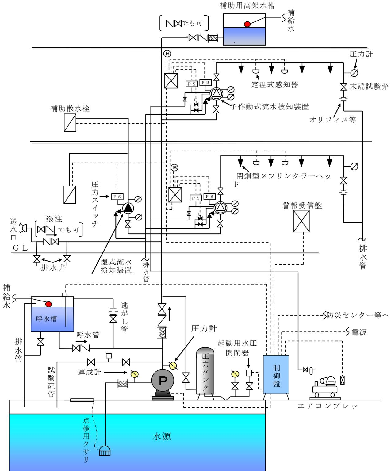
※注：送水口の逆止弁・止水弁の並びは、送水口側に逆止弁が好ましい。
