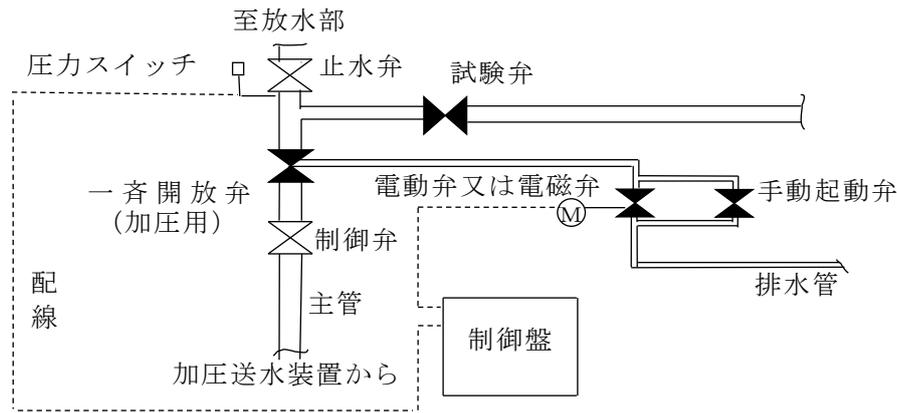
第 4-20 図 (加压方式の一斉開放弁等の廻りの配管図例)
