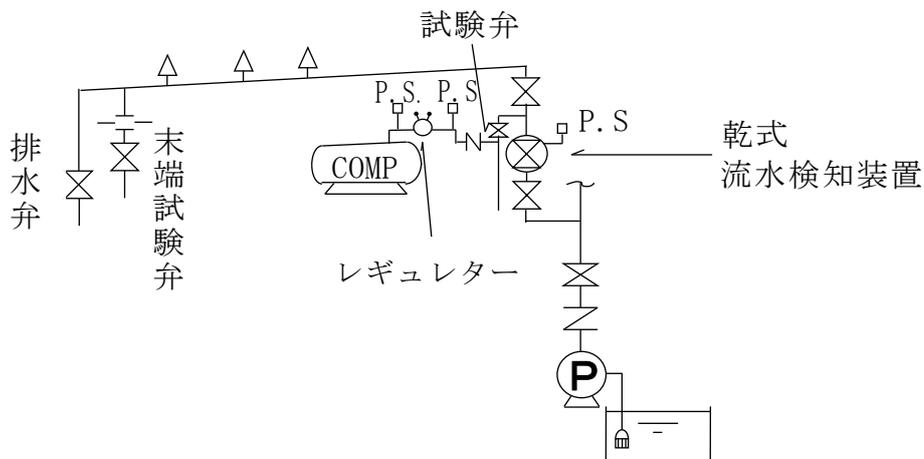
第 4 - 34 図 乾式流水検知装置の場合
