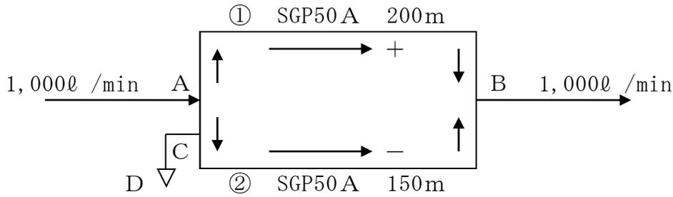
a 配管①及び②に流れる仮想流量（任意の値を設定）をそれぞれ 500ℓ /min と想定し、配管の摩擦損失水頭を摩擦損失基準により求める。
