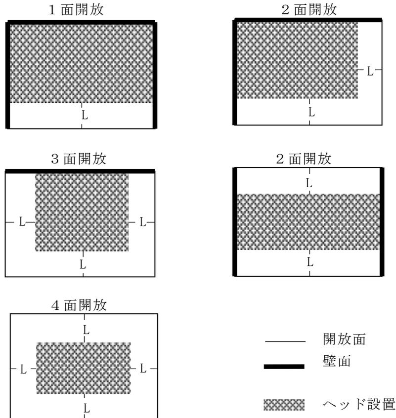
[網かけ以外部分=外気が流通する場所 L = (ア) 概ね5m or (イ) 概ね開口高さ]
