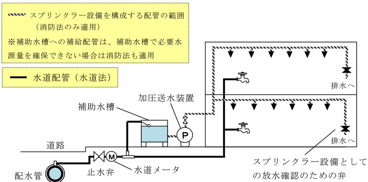
(2) 専用ポンプを設ける特定施設水道連結型スプリンクラー設備（前(1).⑦のみが該当）
