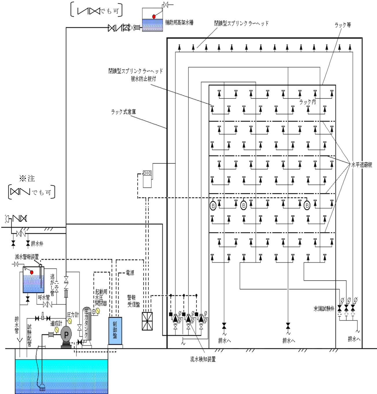
※注：送水口の逆止弁・止水弁の並びは、送水口側に逆止弁が好ましい。
