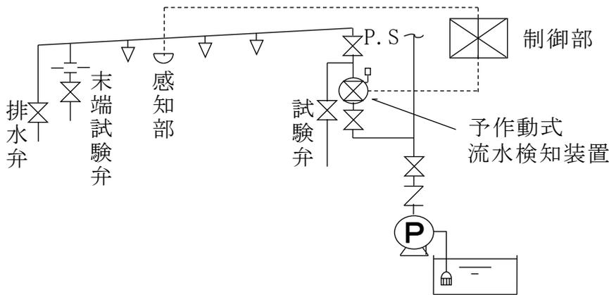
第 4 - 33 図 予作動式流水検知装置の場合
