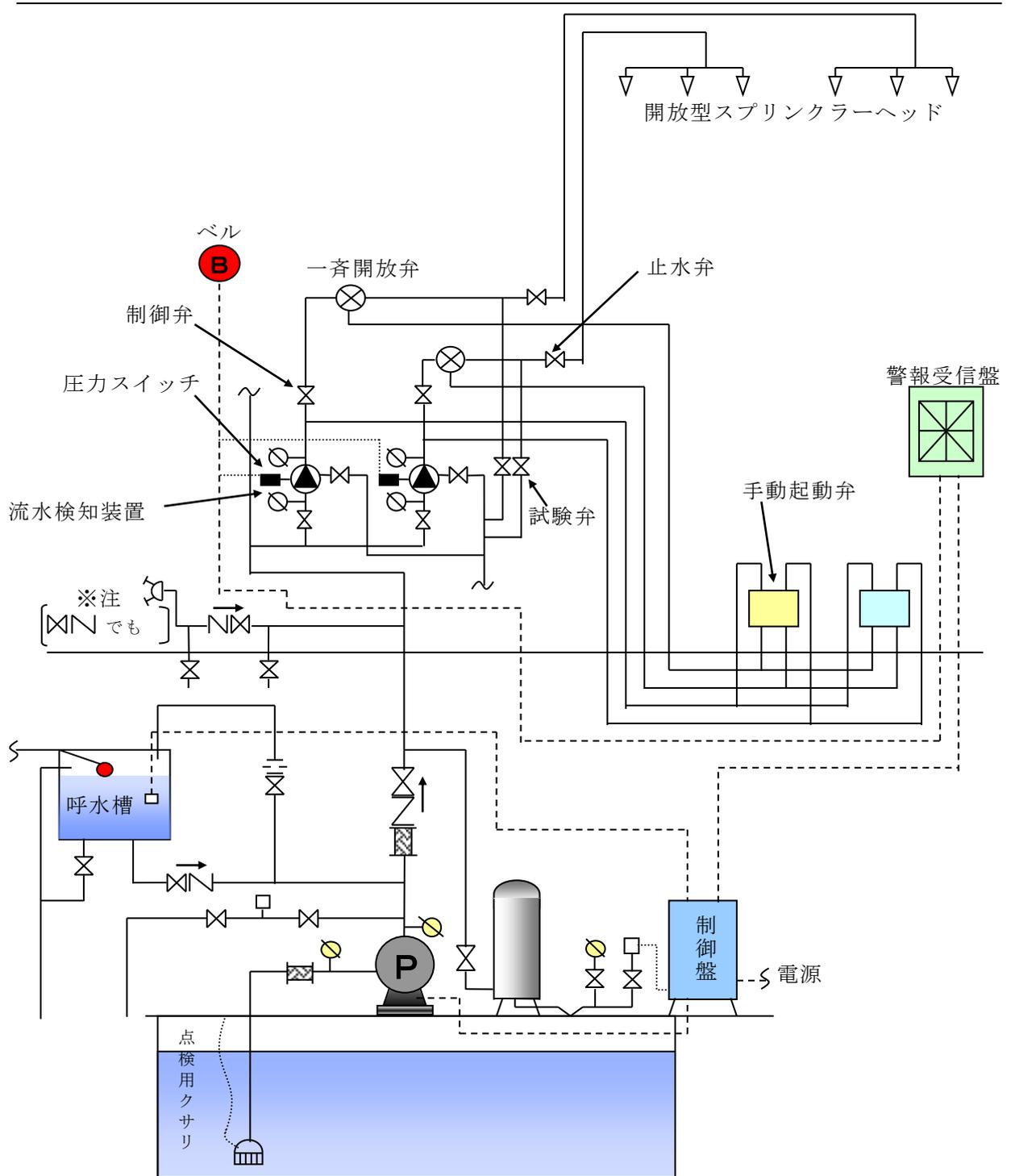
※注：送水口の逆止弁・止水弁の並びは、送水口側に逆止弁が好ましい。
