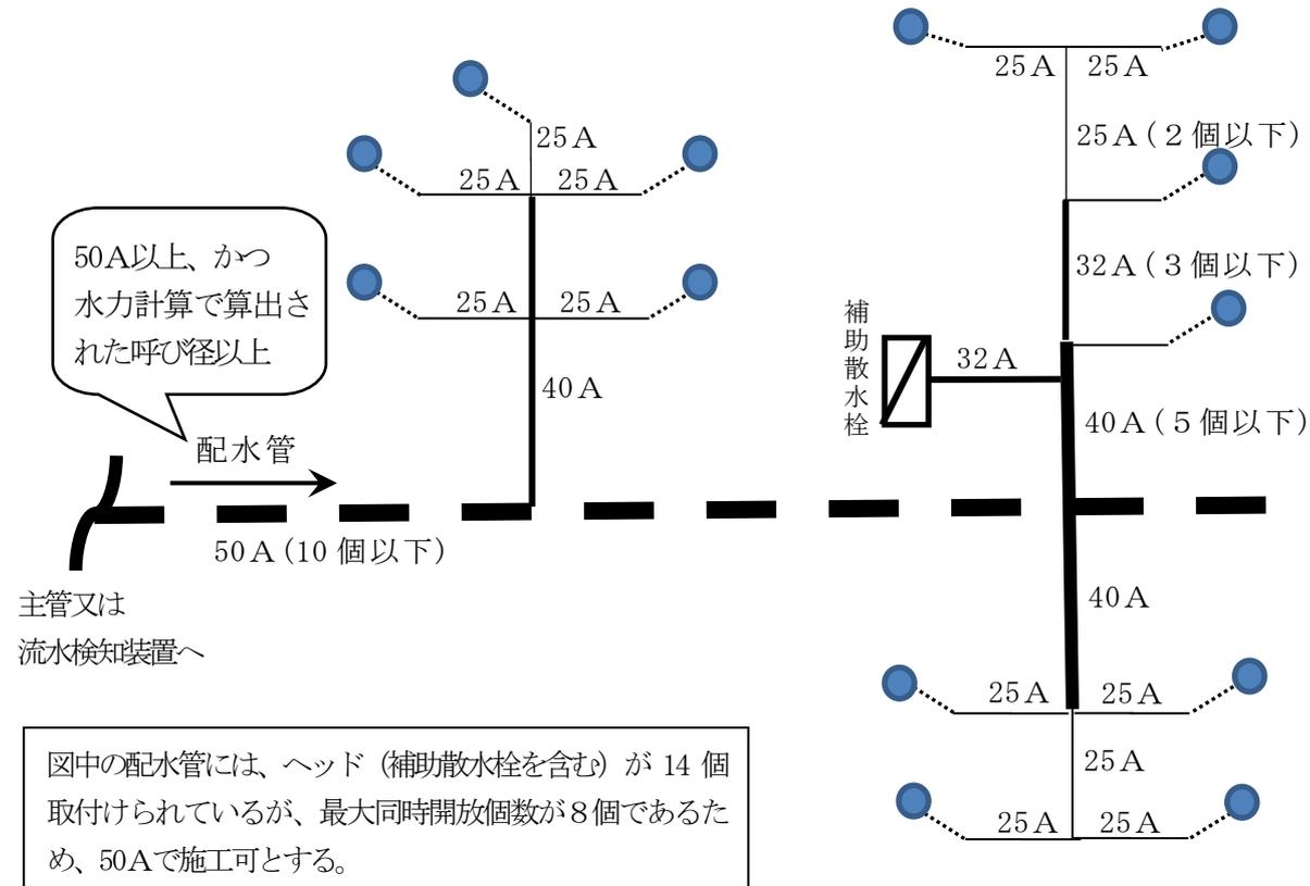
第 4-6 図 配置の設置例：標準型ヘッド (最大同時開放個数 8 個) の場合
