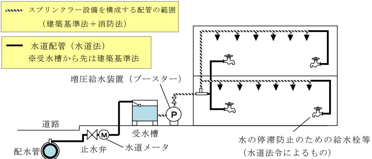
⑦ 受水槽式（直結・補助水槽併用式）
