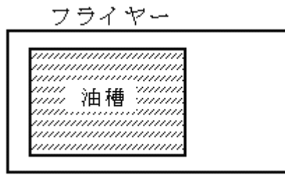
第33-9図 フライヤーの被防護面積
