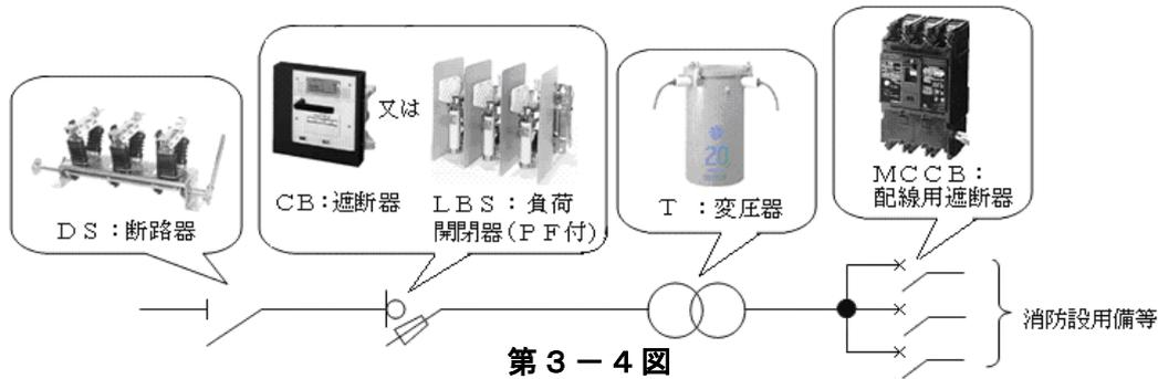
イ 消防用設備等の受電用遮断器(CB2又はLBS2)を専用に設ける場合は、一般負荷用受電用遮断器(CB1又はLBS1)と同等以上の遮断容量を有すること。また、配線用遮断器(MCCB)は、受電用遮断器(CB2又はLBS2)より先に遮断するものを設けること。
