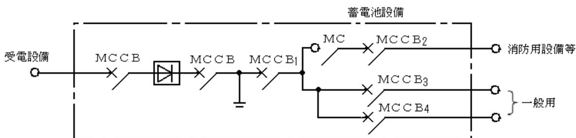
(注) 主遮断器MCCB1は過負荷及び短絡時にMCCB2、MCCB3、MCCB4より先に遮断しないものとする。
