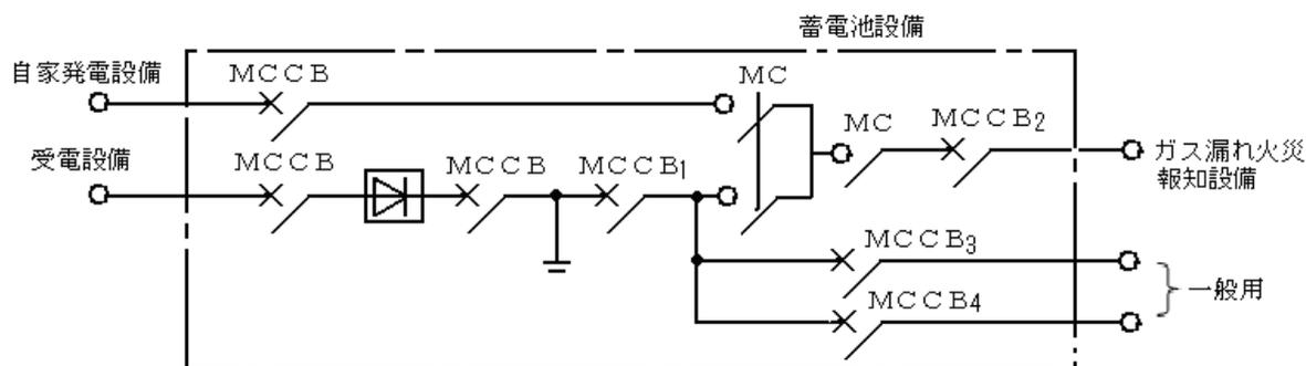
(注) 主遮断器MCCB1は過負荷及び短絡時にMCCB2、MCCB3、MCCB4より先に遮断しないものとする。
