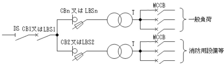
③ 第3-7図に示すように、一般負荷と共用する変圧器を次により設け、消防用設備等へ電源を供給する場合
