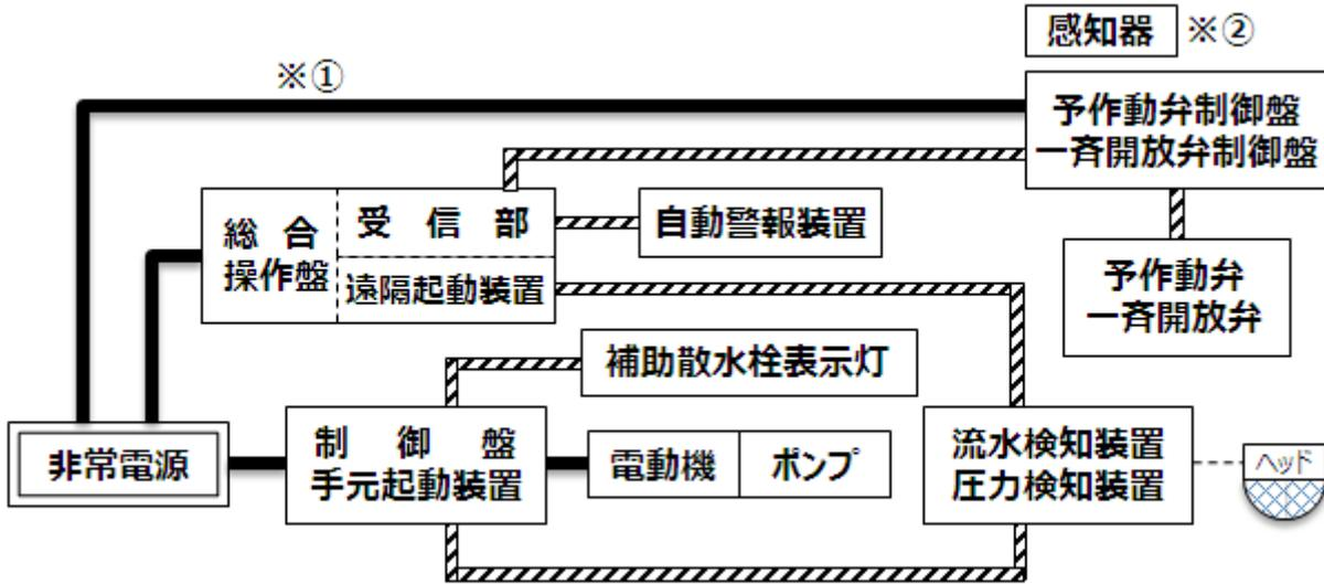
※① 予作動弁制御盤に蓄電池を内蔵している場合は、一般配線でよい。
