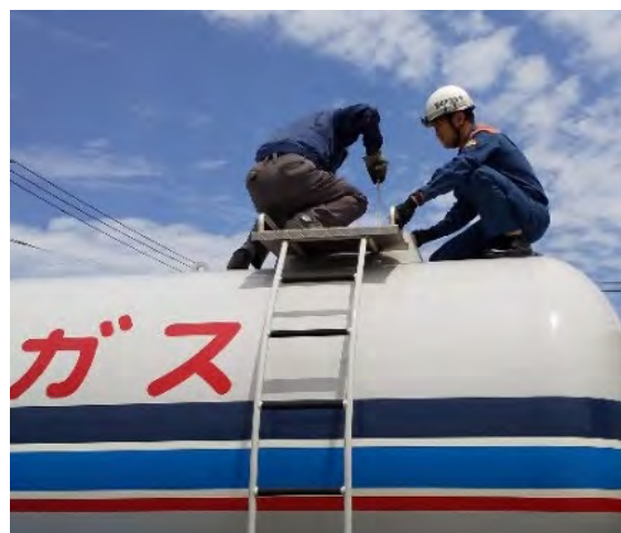
高圧ガ스로リーの保安検査
