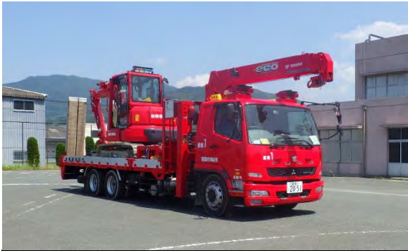
重機及び重機搬送車
